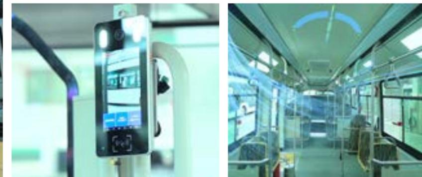
Saat penumpang masuk bus, system *Artificial Intelligence* (AI) atau kecerdasan buatan yang dipasang di sebelah mesin tiket. Alat itu akan melakukan pengecekan wajah penumpang dan mengecek suhu thermal badan menggunakan infrared. Sistem ini juga secara otomatis mengidentifikasi apakah penumpang menggunakan masker. Sumber: prnewswire.com
